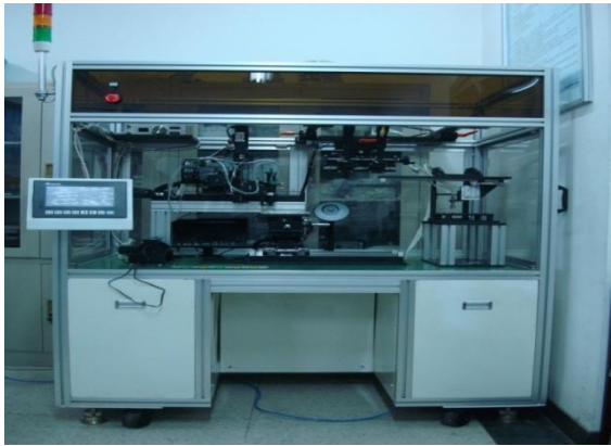
图 4 自主研发的大面积 DSSC 半自动化封装系统设备
