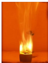
图：功率为 50kW 的天然气有焰（左）和无焰（右）炉内燃烧
