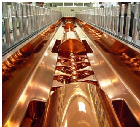
图 11 癌症治疗用重离子直线注入器的 DTL 加速器
