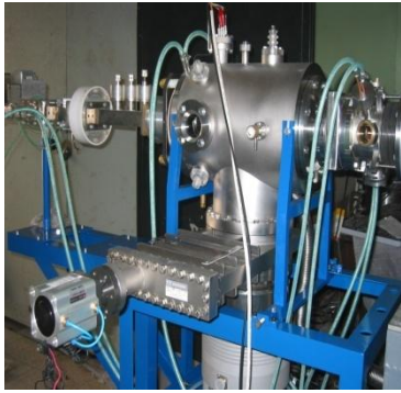
图 7 强流 ECR 离子源，流强几十 mA，多种离子
