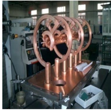
图 2 分离作用 RFQ 加速器
